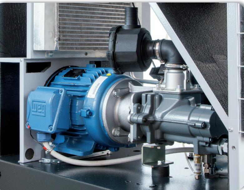
Новые компрессоры серии IVR с прямым приводом отличаются очень низкими требованиями к потребляемой энергии и обеспечивают наиболее широкие возможности регулировки среди компрессоров данной категории.
